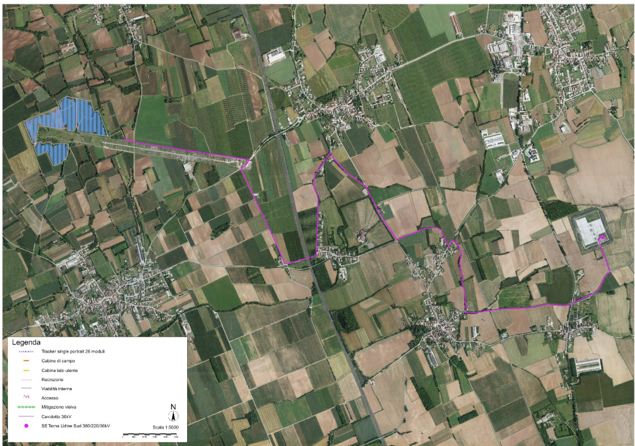
Figura 3- Layout di impianto e opere di connessione su ortofoto
