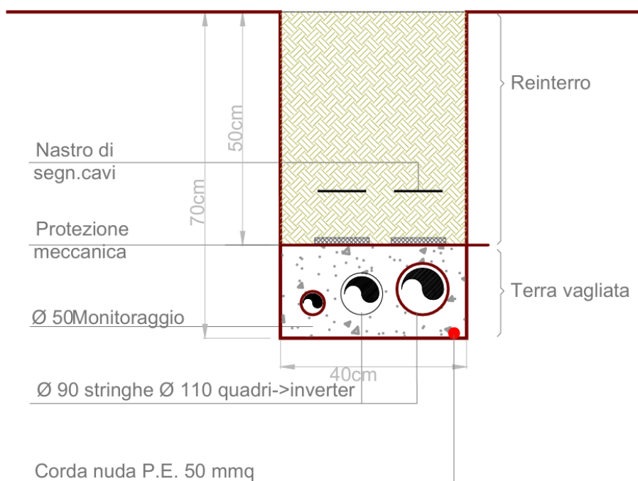
Figura 40- Sezione tipo di cavidotti interrati BT in area agricola
